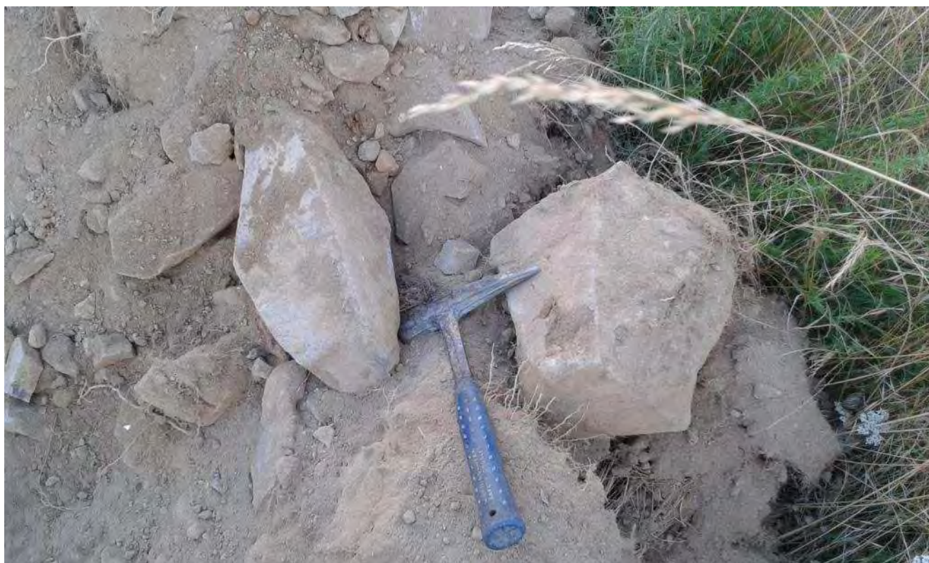
Material extraído en la cata C-2, donde se puede observar un suelo residual arenoso que contiene fragmentos de roca
